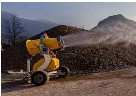
Figura: Bagnatura dei cumuli mediante nebulizzazione e copertura dei cumuli con teloni
