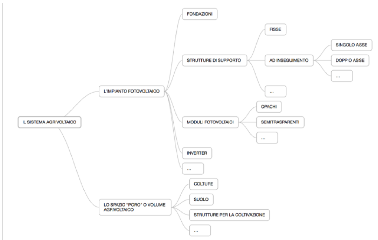
Figura: Le due parti che compongono il sistema agrivoltaico, e cioè il sistema fotovoltaico e lo spazio poro, possono essere scomposte in sottosistemi.
